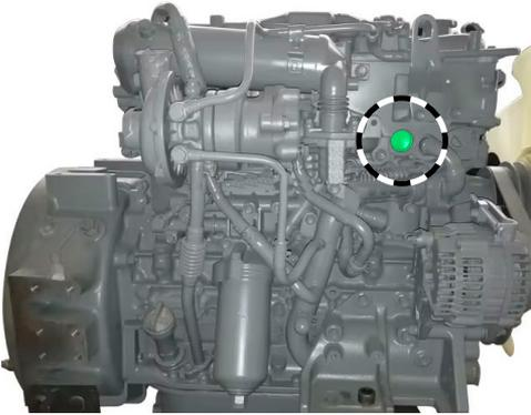
(SV) Demontera  $\varnothing 32$  mm frostpluggen. Frostpluggen kan demonteras genom att borra ett  $\varnothing 8$ - $\varnothing 10$  mm hål mitt i frostpluggen max 5mm igenom och sen försiktigt bryta bort med ett dorn eller dyl. Eller demontera frostpluggen med Plug-out 30/33, p/n 1769011
