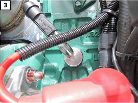
(FI) Täytä hyväksytty jäähdytysneste ja tyhjennä jäähdytysjärjestelmä. Käynnistä moottori lämpimänä ja tarkista, ettei vuotoja ole.
