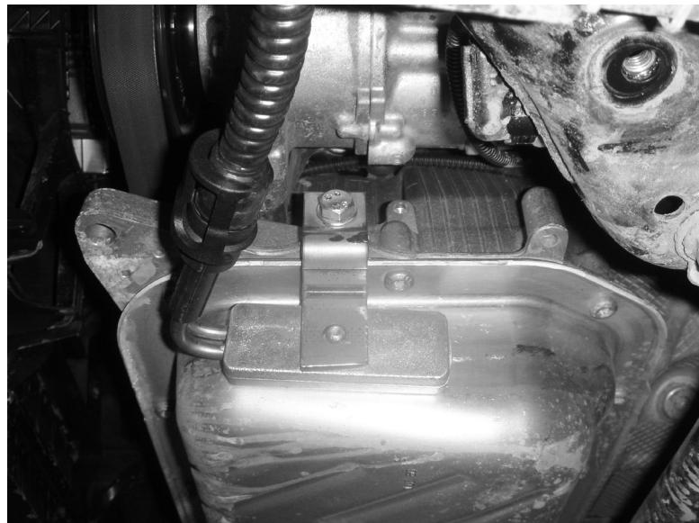
Monterad värmare utan klimatkompressorfäste.
