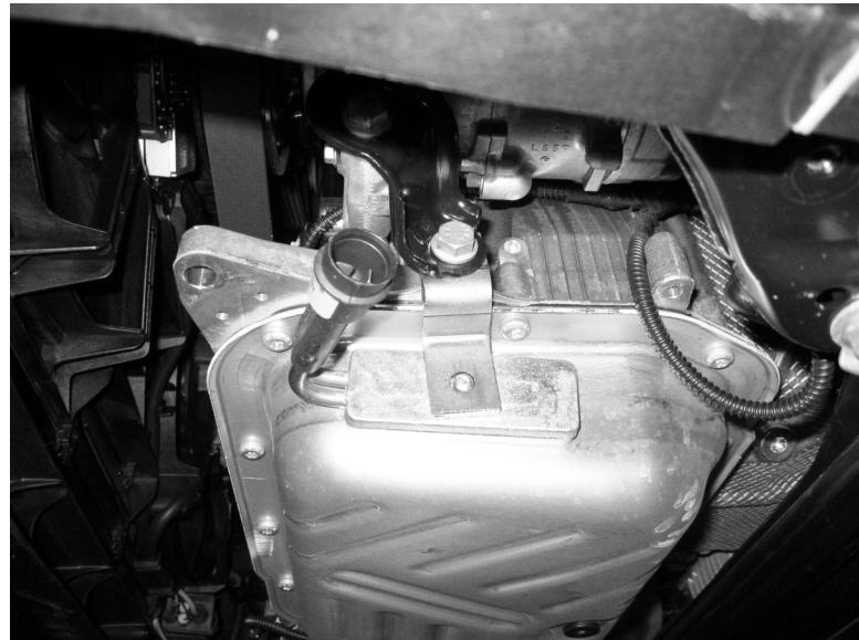
Monterad värmare med klimatkompressorfäste.
