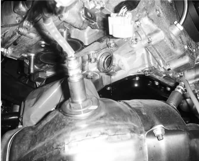
\*Lossa kontakterna till avgasgivarna (2 st). Lossa grenröret på motorns undersida (6 skruvar) och dra ner grenröret så pluggen kan skruvas ur (täck grenröret med plast så det inte kommer in kylvätska). Skruva ur pluggen. Rengör gängorna. Montera värmaren (använd gängtätning) med kontakten mot bilens front (ovanför slanganslutningen där sådan finns). Det underlättar att ta bort spärringen och ta isär värmaren vid monteraget.
