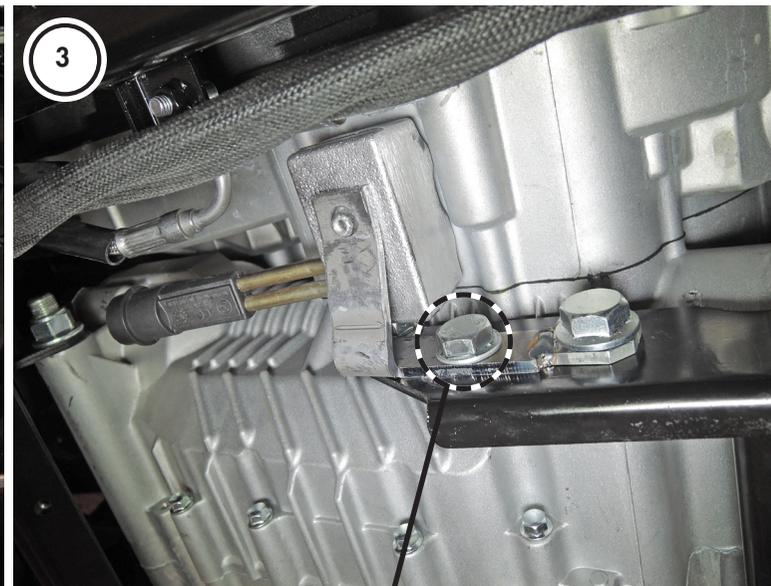
**OBS!** Montera medföljande skruv och bricka här.
