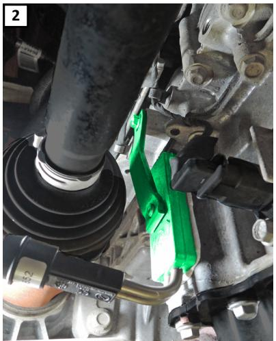
**FI** Käytä aina riittävää määriä pakkasnestettä. Levitä tasaisesti lämpööjohtava pasta lämmittimen pintaan, kohtaan joka on kosketuksessa moottoriin. Asenna lämmitin moottoriin ja kiinnitä lämmitin mukana toimitetulla puristimella ja ruuvilla.
