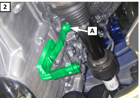
(SV) Demontera skyddet under motorn. Rengör området där värmern ska placeras. Demontera skruv (A).
