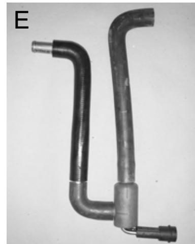
Värmare med slangar monterad.
