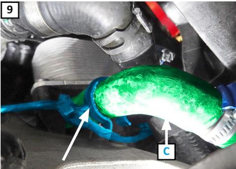
(SV) Montera det lossade kabelfästet på slang (C).
