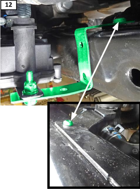
(SV) Lossa skruven på balken. Montera det böckade fästet på balken (55mm) med den lossade skruven. Montera värmaren på det böckade fästet 70mm med medföljande M6 skruv och mutter.
