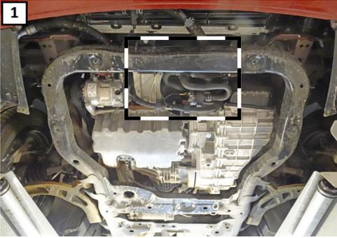
(SV) Demontera skyddet under motorn. Monteringen sker underifrån. Monteringsområde. Töm motorn på kylavätska.
