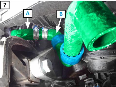
(SV) Montera slang (A) och slang (B) med medföljande slangklämma.
