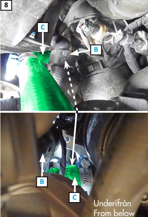
(SV) Montera slang (C) till oljekylarens anslutning med medföljande slangklämma. Slangklämman kommer man bäst åt underifrån.
