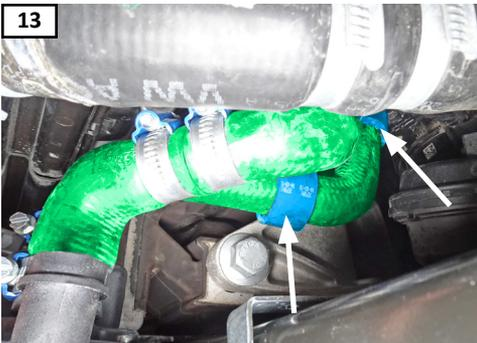
(SV) Placera distansringarna vid motorfästet och kabelklipset vid oljefiltret.
