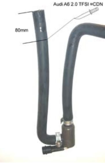
\*Montera slangarna på värmaren enligt bilden. Slangen med korta ändan på värmarens sidostos.
