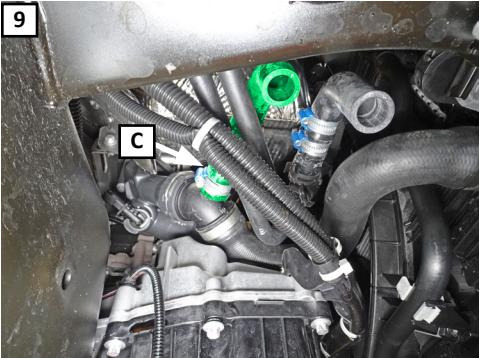
**(SV)** Installera slang [C] till vattenrörets anslutning med medföljande slangklämmor.
