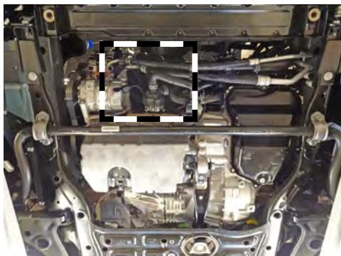
**SE** Demontera skyddet under motorn. Töm motorn på kylvätska.
